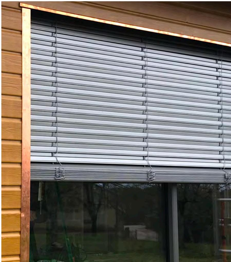
Les stores à lamelles orientables de dernière génération permettent de réguler à volonté l'éclairage jusqu'à un obscurcissement optimal. La forme des lamelles, d'une largeur de 90 ou 70 mm, est étudiée pour atténuer le bruit et les reflets de lumière. Le profil des lamelles en "Z" assure une rigidité garante d'un fonctionnement rigoureux (fermeture, empilement,...). Par ailleurs les perforations des lames sont réduites afin de limiter le passage de la lumière.
