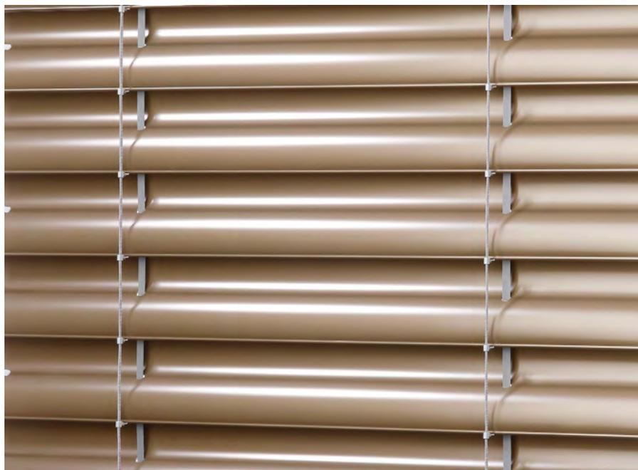
Les stores à lamelles orientables de la gamme AS permettent une réfraction optimale de la lumière grâce à la forme en "S" des lames. La forme des lamelles, d'une largeur de 65 ou 95mm, est étudiée pour atténuer le bruit et les reflets de lumière. Par ailleurs les perforations des lames sont réduites afin de limiter le passage de la lumière.
