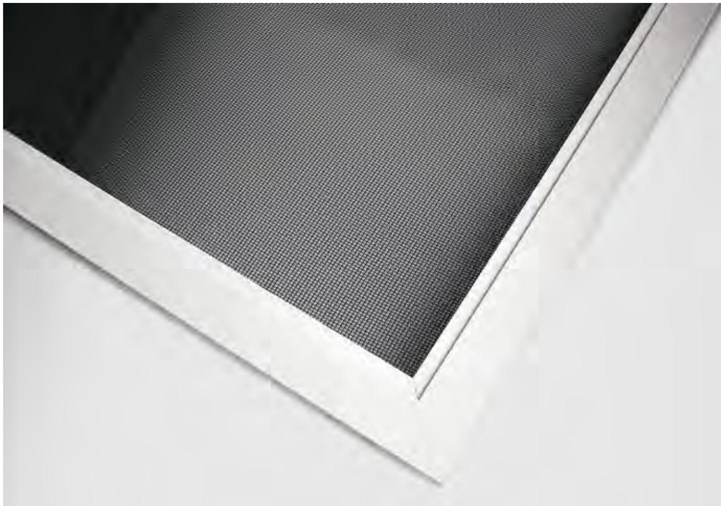
Le cadre fixe FC16, disponible en 5 profils de profondeur variable de 16 à 41 mm, est conçue pour se clipser dans le guichet de la fenêtre. Fixation par 2 ressorts inox en haut et en bas, le cadre fixe FC16 n'entraîne en principe aucun travail d'installation : Insérer le haut et clipser le bas. La moustiquaires peut ainsi être très aisément mise en place et démontée.
